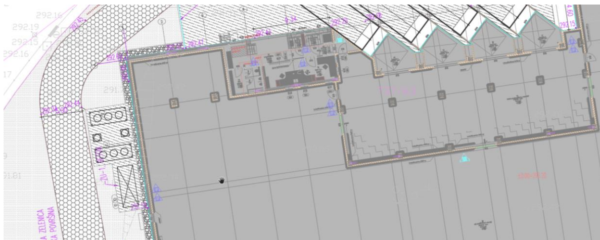
Slika 7: Detajl namestitve hladilne tehnike ob Z fasado in nakladalnih ramp ob S fasado
